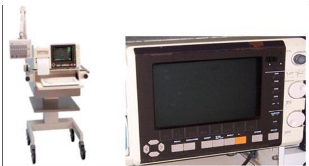
**Fig. 1.** Vista del Neuropack Four Mini. A la derecha, una vista ampliada de la interfaz del módulo de procesamiento y graficación de este equipo
